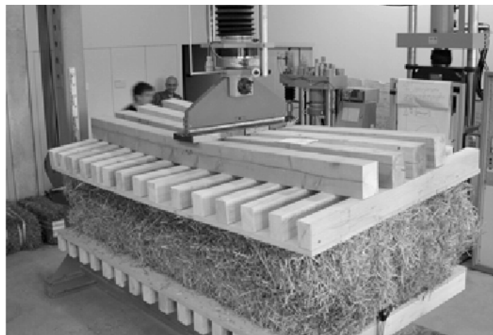
Essais de résistance à la compression, 2001, HTW, Coire, Suisse.
