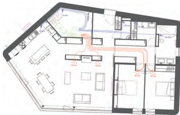
Fig. 8.2 Le positionnement de la VMC double flux Source : Energelio
